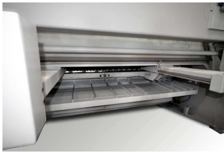
3-х ступенчатая система поддержки листа
